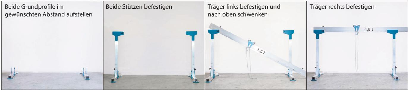
Träger und Stützen sind aus leichten Aluminiumprofilen gefertigt. Die Montage kann daher schnell durch eine Person erfolgen. Die Spannweite ist auf einer Seite im Abstand von 300 mm verstellbar. Die Höhe kann im Raster von 100 mm auf jeder Seite über Steckbolzen variiert werden. Eine kugelgelagerte Laufkatze mit Feststeller gehört zum Lieferumfang. Durch Drücken gegen die Last kann diese leicht verfahren werden.
