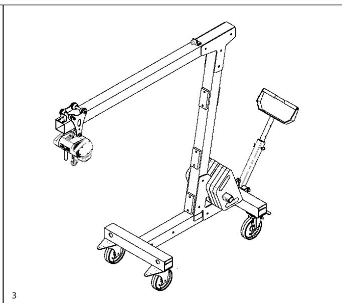
Durch das Baukastensystem ist der Kran, je nach Montage, als Auslegerkran (Abb. 2) oder als Unterfahrkran (Abb. 3) einsetzbar.
