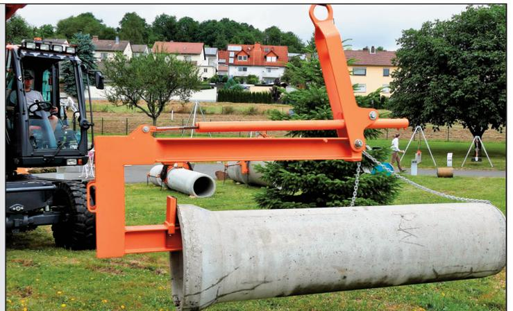
\* Für die Funktion des Schwerpunktausgleichs ist ein Mindest-Rohrgewicht notwendig. Leichtere Rohre können mit dem RHSV nicht transportiert werden.
