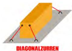
Bei dieser Methode ist die **zul. Zugkraft (LC = Lashing Capacity)** zur korrekten Auswahl der Zurrketten zu berücksichtigen. Die zul. Zugkraft ist die Höchstkraft mit der eine Zurrkette im geraden Zug belastet werden darf. Hier haben die Zurrketten die Aufgabe das Ladegut in Position zu halten.
