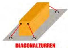
Bei dieser Methode ist die **zul. Zugkraft (LC = Lashing Capacity)** zur korrekten Auswahl der Zurrrketten zu berücksichtigen.
