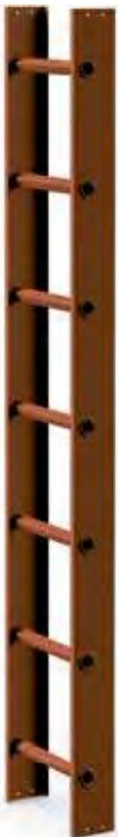
Sicherer Aufstieg auf verschiedenen Dachneigungen durch hochstabile, stationäre Leiter mit außermittiger Sprossenordnung. Trittsichere Vierkantsprossen mit 2 unterschiedlich geneigten Trittflächen. Stabile Holzprofile für 80 mm Sicherheitsabstand der Sprossen zur Dachoberfläche. Problemlose Abstimmung der Leiter auf die jeweilige Dachlänge.
