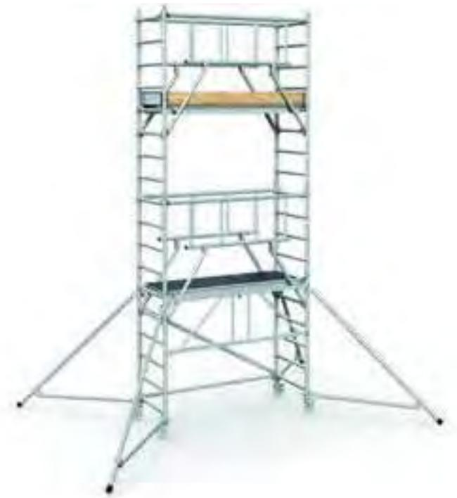
Sicherer und schnellerer Aufbau durch vorlaufende Geländer und Plattformen im 2m-Abstand. Einfache Einhandbedienung des Klapprahmens mit robustem Arretierknopf: Feststellen und lösen mit nur einem Klick. Patentierte Bordbrett-Einheit: Schnell platziert, schnell fixiert. Leichtlauf-Aufsteckführung aus Hartkunststoff: Kein Verkanten beim Zusammenführen der Aufsteckrahmen.
