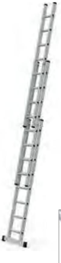
Flexibel, sicher und preisgünstig: die perfekte Lösung für große Höhen. Bequem und präzise von Sprosse zu Sprosse im Raster von 280 mm höhenverstellbar. Oberleiter auch separat als Anlegeleiter einsetzbar bei Bestell-Nr. 44851-44852. Stabile Dreieckssprosse aus Strangpressprofil mit waagrechttem Auftritt in Gebrauchsstellung.
