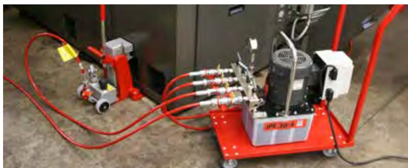
Elektropumpe JPE 30/4 NVR mit 4 Hebegeräten im Einsatz
