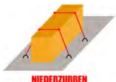
Bei dieser Methode ist die **Vorspannkraft (STF = Standard Tension Force)** zur korrekten Auswahl der Zurrrketten zu berücksichtigen.
