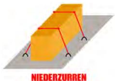
Bei dieser Methode ist die **Vorspannkraft (STF = Standard Tension Force)** zur korrekten Auswahl der Zurrketten zu berücksichtigen. Die Vorspannkraft ist die Kraft die beim Niederzurren über die Handkraft (SHF) erzeugt wird. Mit dieser Vorspannkraft wird das Ladegut auf die Ladefläche gedrückt und erhöht die Reibungskraft (Sicherungskraft) zwischen Ladegut und Ladefläche.
