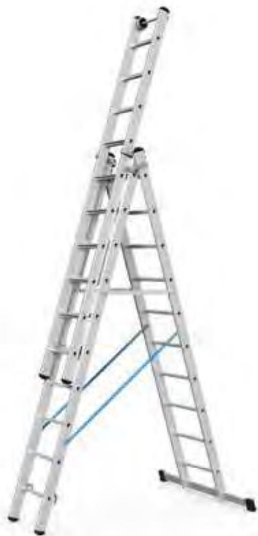
Eine Leiter, viele Funktionen: die flexible Lösung für sicheren Auf- und Abstieg sowie extra stabilen Stand, besonders komfortabel und extra sicher durch 80 mm tiefe Stufen an der Oberleiter. Höchste Stabilität durch beidseitige starre Verbindung. Mit Rolle in Quertraverse für ergonomischen Transport. Oberleiter mit Kopffahrwerk (ab Größe 3 x 8). Oberleiter auch separat als Anlegeleiter einsetzbar bei Bestell-Nr. 41577-41579.
