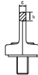
Bild 1: Zulässiger Verschleiß (Richtung b und c) max. 10%
