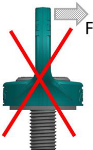
Bild 2: Der Anschlagpunkt darf nicht quer zur Laststrichtung belastet werden.
